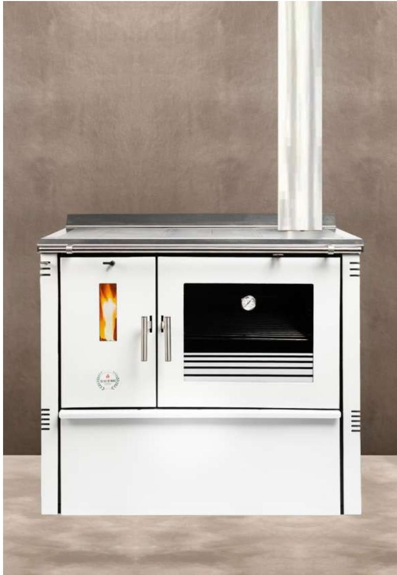
La cuisinière à bois émaillée blanche PV est une combinaison du traditionnel et du contemporain. La structure interne est fabriquée en tôle d'acier spéciale de 2mm, le four en acier inoxydable de 1,5mm et le dessus en acier inoxydable de 6mm de épaisseur. La porte du foyer a un verre de haute température de 4mm d'épaisseur avec traitement thermique jusqu'à 900 ° C. La porte du four a un verre trempé avec des lignes blanches décoratives.
